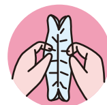
●接着状態をチェック（冷却後、シール部を左右に引っ張ってみる。剥がれれば加熱不足）
